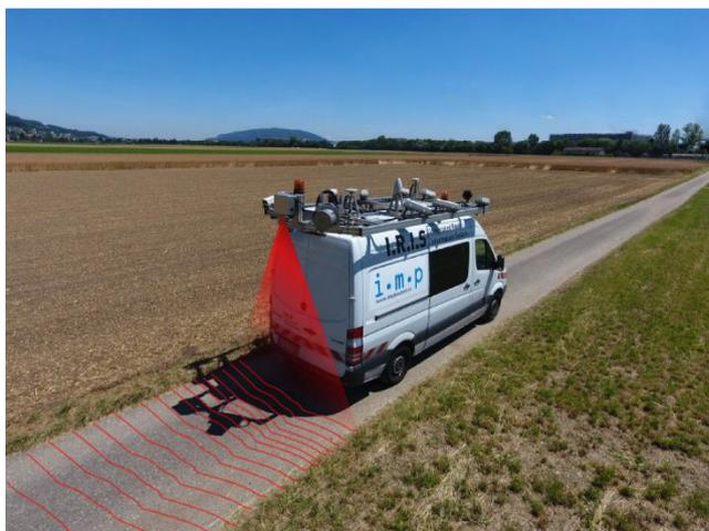
***Messprinzip der laserbasierten Erfassung der Strassen-Oberfläche***
