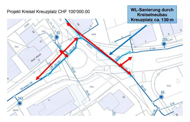
Diese Investitionen sind im Investitionsplan 2019 – 2023 enthalten. Der Sanierungsbedarf entstand dadurch, dass sich in den vergangenen Monaten verschiedene Wasserleitungsbrüche in diesen Gebieten ereignet haben. Daher ist es sinnvoll, diese Abschnitte zu sanieren.
