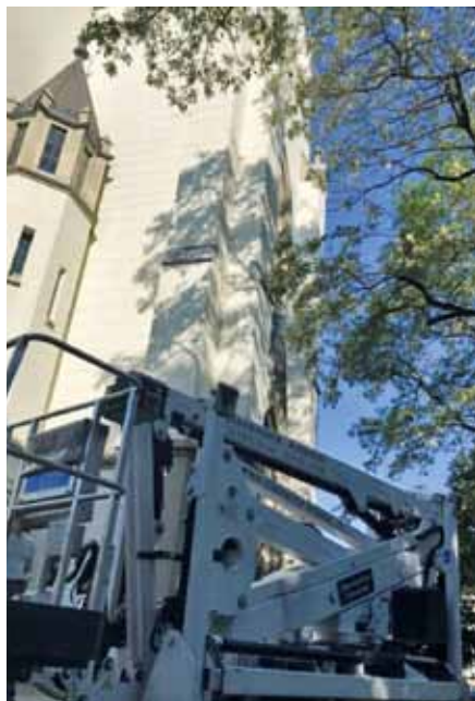
Die Hebebühne «Weisse Maria» erreicht bis 28 Meter. Foto: Stuckatura Antonini AG
